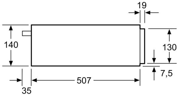
Über eine Vakuumierschublade können Kompakt-Backöfen mit einer Gerätehöhe von 455 mm eingebaut werden. Ein Zwischenboden ist nicht erforderlich.
