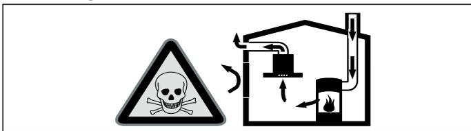
Vuurbronnen die de lucht in de ruimte verbruiken (bijv. apparaten die op gas, olie, hout of kolen worden gestookt, geisers, warmwatertoestellen) trekken de verbrandingslucht uit de opstellingsruimte en voeren de gassen via een afvoer (bijv. schoorsteen) af naar buiten.
