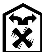
L'air aspiré se nettoie en traversant les filtres à graisse et un filtre à charbon actif, puis il revient dans la cuisine.
