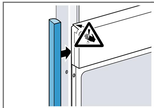
2. Aluprofile vorbohren, um eine Schraubverbindung herzustellen.
