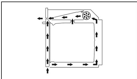
La turbine refroidit l'appareil et se met en marche pendant la cuisson.
