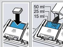
2. Den Deckel der Reinigerkammer schließen.
