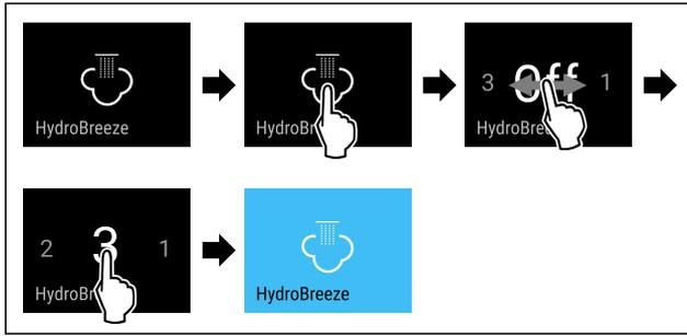
Fig. 47 例图：利用数值3 激活 HydroBreeze。
