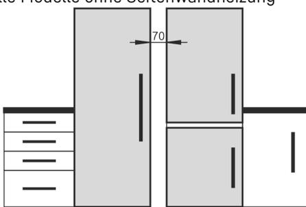
Wird dieser Abstand nicht eingehalten, so bildet sich Kondenswasser zwischen den Seitenwänden der Geräte.
