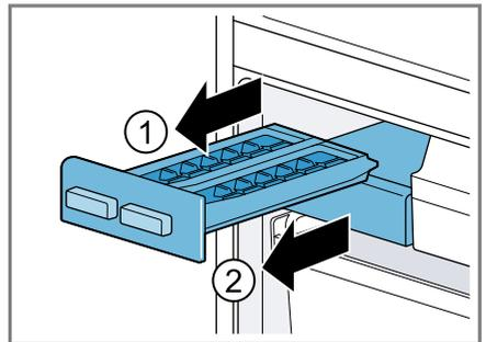
**Eingehängten Gefriergutbehälter entnehmen**
