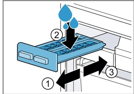
**Hinweis:** Zu viel eingefülltes Trinkwasser kann die Funktion des Eiswürfelbereiters beeinträchtigen. Die Eiswürfel lösen sich nicht einzeln aus der Eiswürfelschale. Zu viel eingefülltes Trinkwasser läuft in den Eiswürfelbehälter, vorhandene Eiswürfel frieren zusammen.
