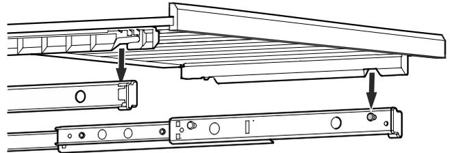
Auszugschienen ganz herausziehen. Das Holzbord mit den vorderen Ausnehmungen auf die Haltebolzen aufsetzen.
